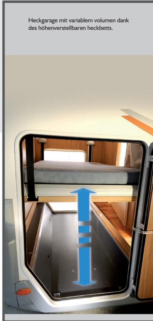
Heckgarage mit variablem volumen dank des höhenverstellbaren heckbetts.
