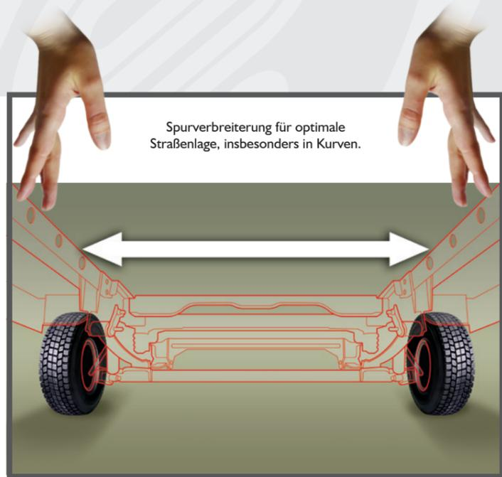
Spurverbreiterung für optimale Straßenlage, insbesondere in Kurven.
