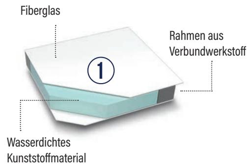
**DACH** AUS EINER DOPPELTEN GLASFASERPLATTE, AUSSEN UND INNEN, EINEM PVC-RAHMEN UND WASSERDICHTEN KUNSTSTOFFEINSÄTZEN, STÄRKE 30 MM
