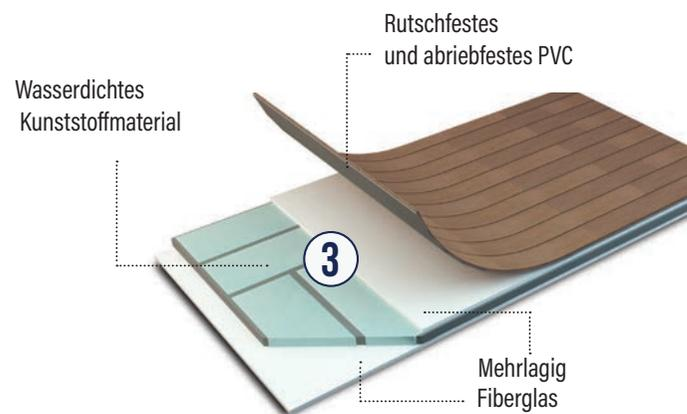
**BODEN** 54 MM DICKE, MIT INNERER RUTSCH- UND ABRIEBFESTER PVC-BESCHICHTUNG, BESTEHEND AUS EINER ÄUSSEREN GLASFASERPLATTE UND EINEM INNEREN MEHRSCICHTIGEN, PVC-RAHMEN UND WASSERDICHTEN KUNSTSTOFFEINLAGEN.
