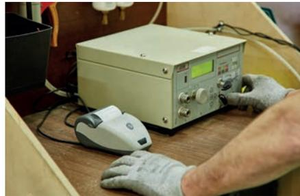
Abnahmeprüfung der Gasanlagen durch zertifiziertes Personal gemäß deutscher DVGW-Vorgaben
