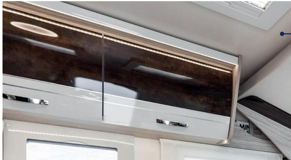
**Installation der Hängeschränke** mit Abstand zur Wand des Wohnmobils. Die Luft wird gleichmäßig verteilt, wodurch Kondensation und Schimmel vermieden werden.
