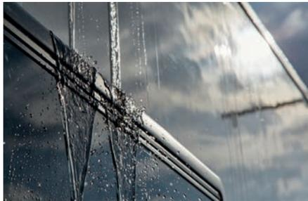
Dichtigkeitsprüfung gegen Wasserdurchsickerung auf 100% der produzierten Fahrzeuge, vor der Auslieferung.
